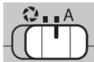
Pour régler l'ouverture manuellement, positionnez le commutateur sur ⚡ et tournez la bague des ouvertures. Tournez la bague vers la gauche pour obtenir de grandes ouvertures (petits chiffres), vers la droite pour obtenir de petites ouvertures (grands chiffres).
