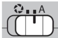
Aby ustawić przysłonę ręcznie, przesuń przełącznik na i następnie obracaj pierścień przysłony. Obróć pierścień w lewo, aby rozszerzyć przysłonę (niższa liczba f), a w prawo, aby zmniejszyć przysłonę (wyższa liczba f).
